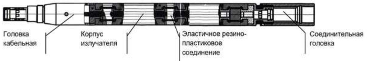
РИС. 2. Конструктивная схема скважинного акустического прибора
